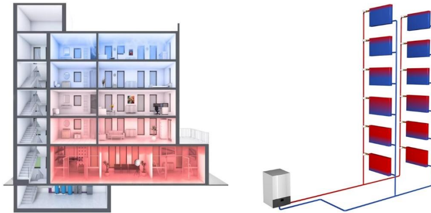
Sl. 3-31: Hidraulički neuravnotežen sustav grijanja (izvor: IMI Heimeier, Danfoss)
