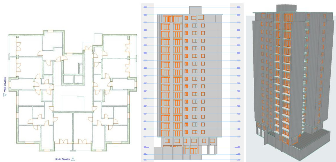
Sl. 2-6: Primjer BIM modela višestambene zgrade izrađenog korištenjem rezultata 3D skeniranja
