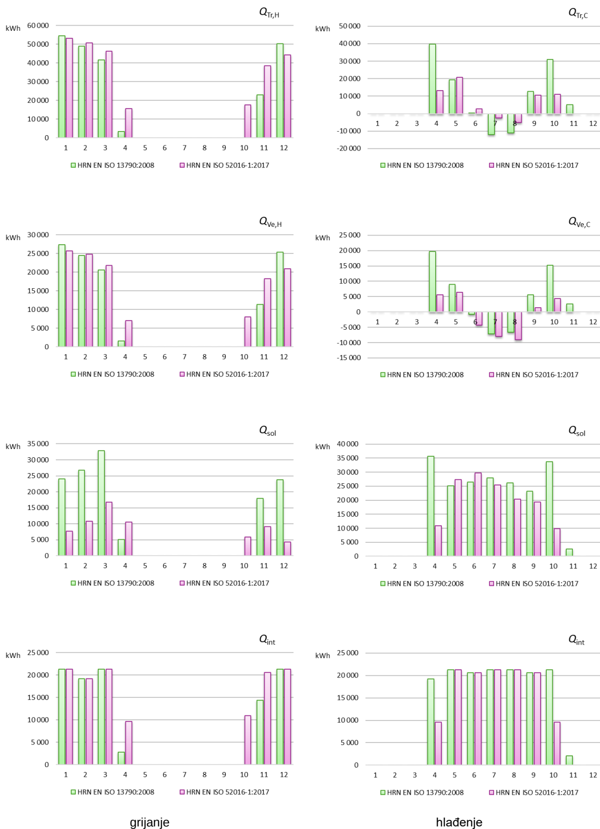
Sl. 2-42: Usporedba ukupnih toplinskih gubitaka i dobitaka kod grijanja i hlađenja stambene zgrade u Rijeci (HR-51000-0357-1)
