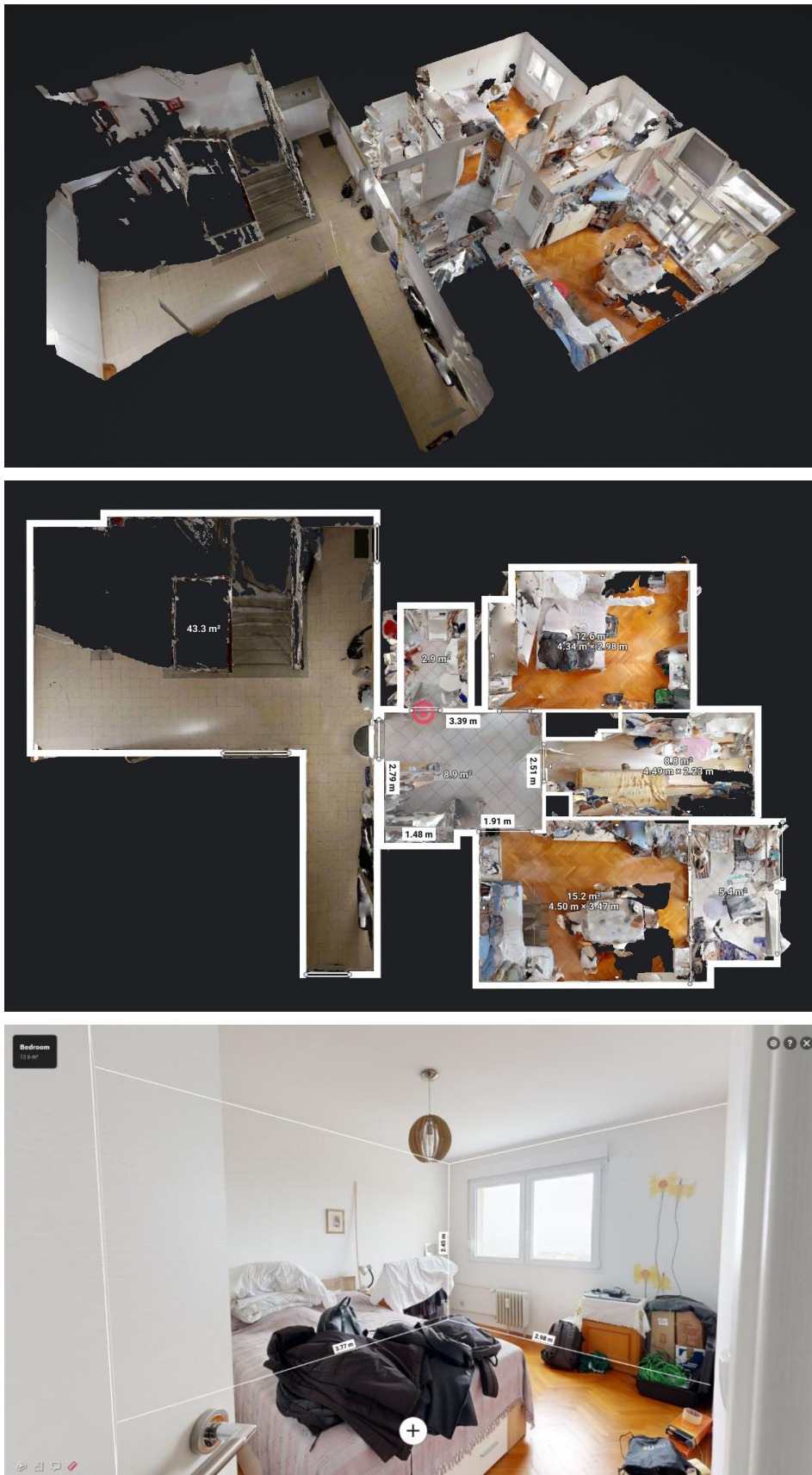
Sl. 2-4: Primjer 3D skena stana korištenjem LiDAR tehnologije
